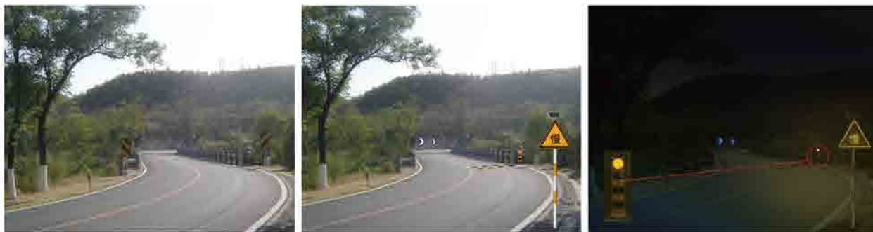
图 2-9 直桥接小半径曲线路段标志改进前后对比图示例
