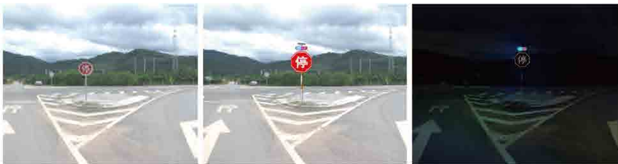
图 2-16 平交路口标志改进前后对比图示例一
